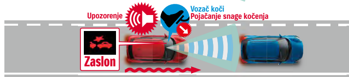
2. Uključuje pomoć pri kočenju, povećava silu kočenja ako je rizik od sudara visok i vozač naglo stišće kočnicu
