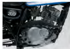
Motor od 199 cm 3 , zrakom hlađen
