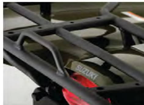
Cijevi nosača prtljage od grubog čelika
