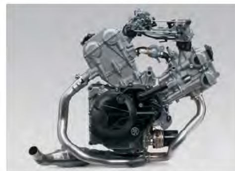
Motor od 645 cm 3 , vodom hlađen, DOHC, V pod 90°
