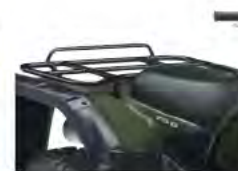
Cijevi stražnjeg nosača prtljage od čelika
