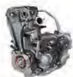
Motor od 450 cm 3 , četvertaktni
