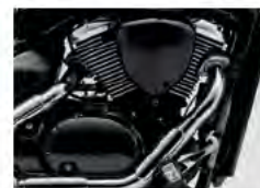
Vodom hlađen motor, V pod 45°
