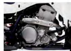
Vodom hlađeni motor od 398 cm 3
