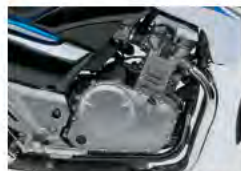
4-taktni, 2-cilindrični, vodom hlađen SOHC motor
