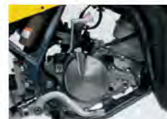
2-taktni motor od 84.7 cm 3
