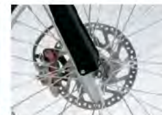
Prednja disk kočnica promjera 220 mm
