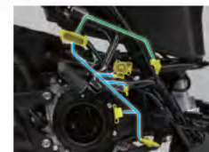
Sustav ubrizgavanja goriva sa 6 senzora
