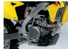
Lagan DOHC motor (4 ventila)
