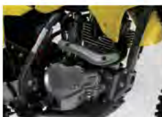
Lagan motor sa zaštitnom pločom
