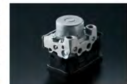
Lagana upravljačka jedinica ABS-a
