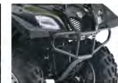
Veliki branik sa čeličnim cijevima i zaštita maske
