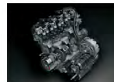
Motor od 1340 cm 3 s dvije bregaste osovine u glavi
