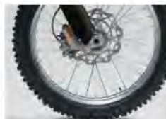
EXCEL aluminijski naplatci i valoviti disk rotori
