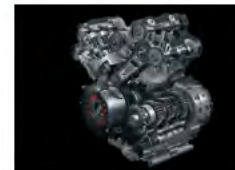
Vodom hlađeni V-twin motor od 1037 cm 3
